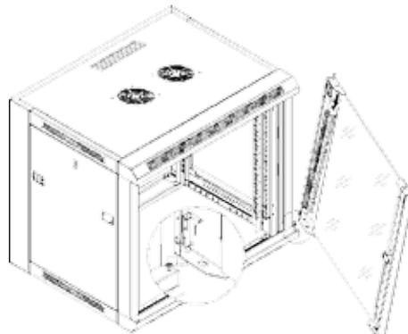
8. Installieren Sie die in Schritt 2 entfernte Fronttür.
