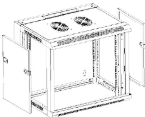
7. Installieren Sie die in Schritt 1 entfernten Seitenwände
