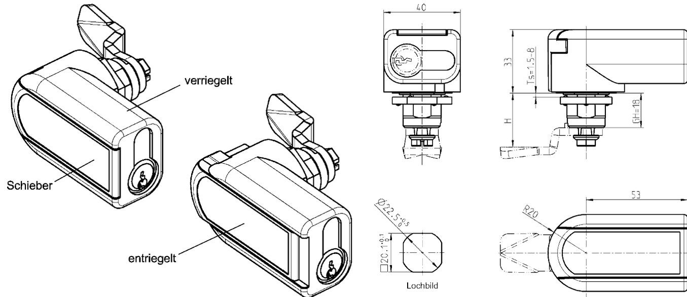
Profilhalbzylinder nach DIN 18252 (EN1303) Maß A=30 entspricht der Gesamtlänge 40.
