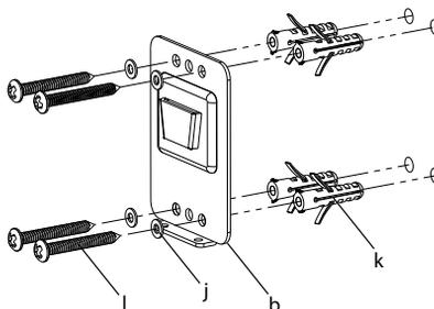
Montaggio su muro con intelaiatura in legno | *Wood Stud Wall Mount*
