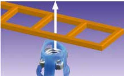
Die Käfigmutter von vorn in den Ausbruch des Profiles einsetzen
